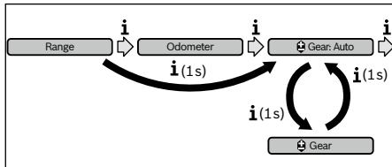
Ved å trykke på knappen «**i**» i mer enn ett sekund kan du veksle mellom den automatiske modusen «**Gear: Auto**»
