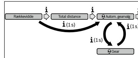
Ved at trykke på tasten „i“ i mere end 1 s kan du skifte frem og tilbage mellem den automatisk modus „**Autom. gearvalg**“ og den manuelle modus „**Gear**“.
