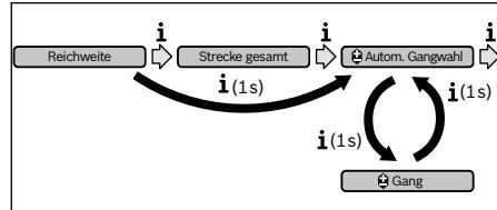
Durch Drücken der Taste „i“ für mehr als 1 s haben Sie die Möglichkeit, zwischen dem automatischen Modus
