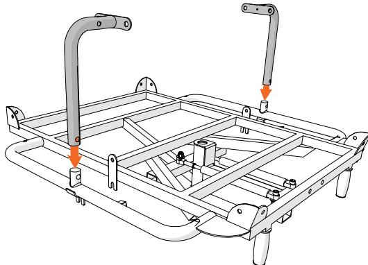
Platzieren Sie die Seitenhalterungen auf den aufrecht stehenden Rohren auf der Oberseite des Rahmens. Stellen Sie sicher, dass die Schraubenlöcher bündig mit der Halterung und dem Rohr sind. (Es kann eventuell sein, dass die Halterung nicht genau auf das Rohr passt. Schmiegeln Sie in diesem Fall ein wenig Lack ab, um es passend zu machen.)
