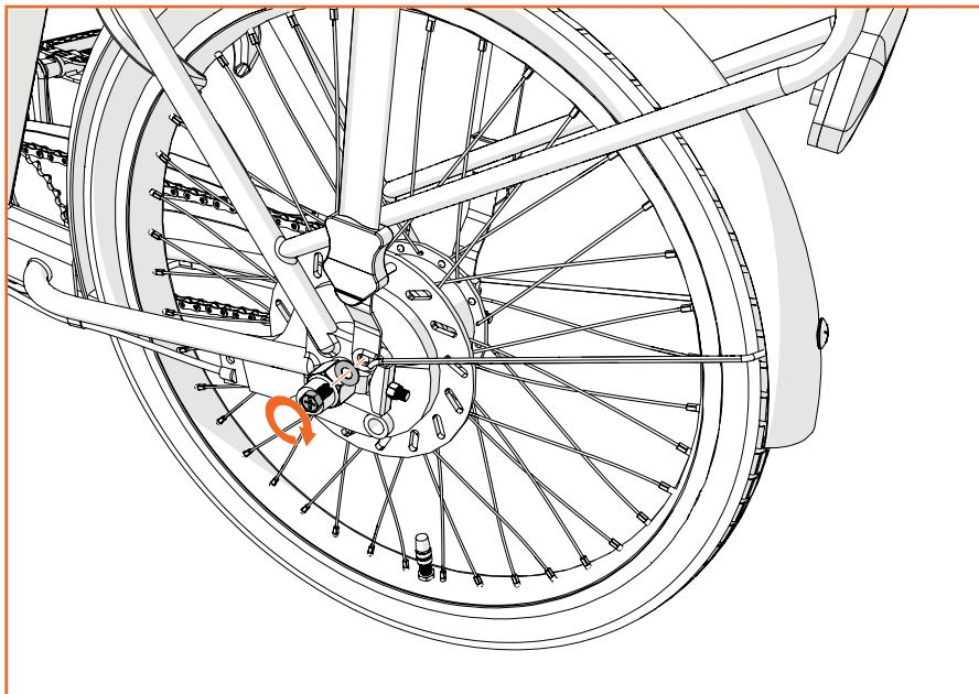
Dévissez la vis et placez la barre de garde-boue. Vissez la barre de garde-boue et répétez de l'autre côté.
