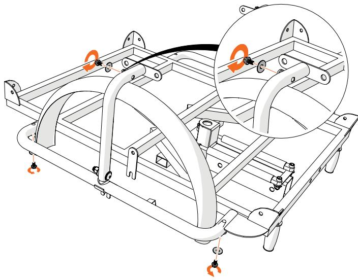
Lösen Sie die Schraube oben an der Halterung. Lösen Sie danach die Schrauben am Rahmen. Platzieren Sie das Schutzblech und ziehen Sie die Schrauben handfest an. Das Ausrichten der Schutzbleche folgt später.
