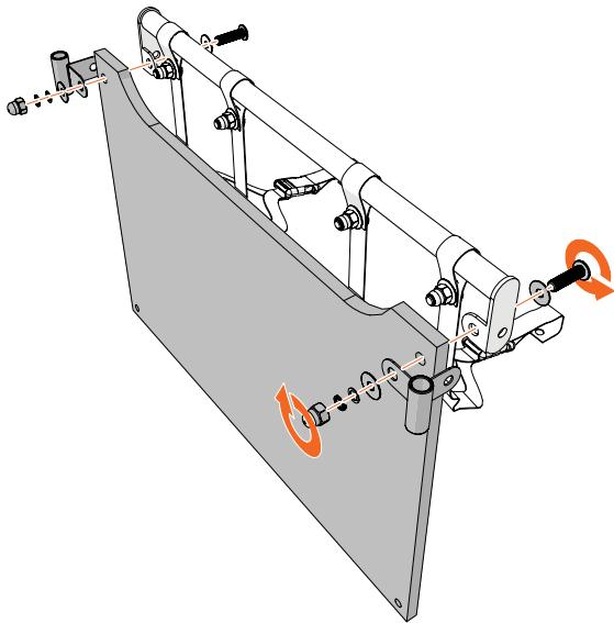
Bevestig het voorpaneel aan de voorstang met boutenset C. Zorg ervoor dat de moeren aan de buitenkant zitten.
