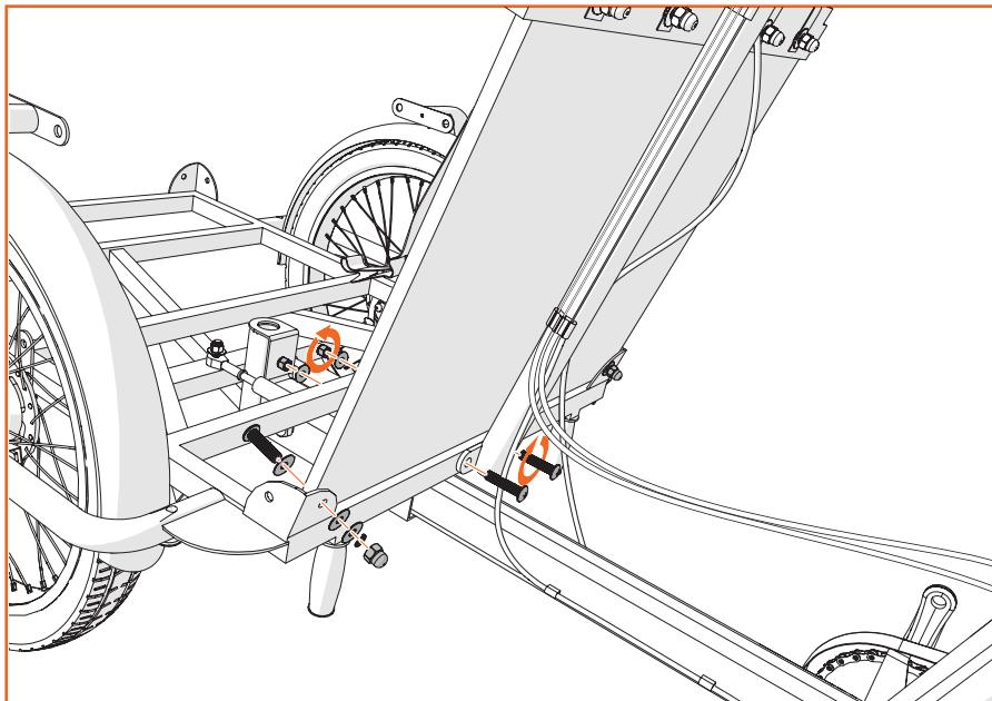
Platzieren Sie die Rückwand mit dem T-Stück auf dem vorderen Rahmen. Stellen Sie sicher, dass die Bremskabel nicht verdreht sind und die Gurte nicht zwischen den Rahmen und die Rückwand gelangen. Befestigen Sie das T-Stück mit Schraubensatz E am vorderen Rahmen. Befestigen Sie anschließend mit Schraubensatz C die Rückwand am vorderen Rahmen. Ziehen Sie die Schrauben C nicht zu fest an.
