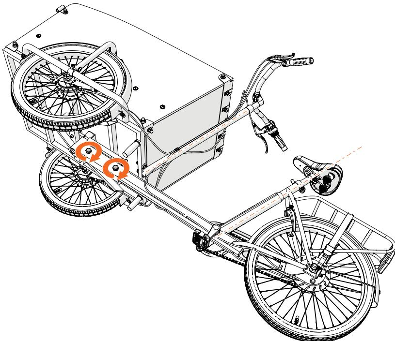
Bitten Sie bei diesem Schritt eventuell jemanden um Hilfe. Stellen Sie sicher, dass die Sattelstütze bündig mit der Steuerfeder ist. Ziehen Sie die Muttern so fest wie möglich an, während Sie (oder eventuell jemand anders) den Rahmen ausrichtet. Ziehen Sie nach den ersten Fahrten die Muttern noch einmal fest nach.
