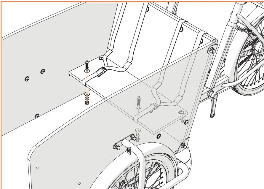
Bevestig de hoekstukken op een van de bankjes met boutenset C. Plaats het bankje tegen het achterpaneel en gebruik boutenset B om het bankje aan de zijpanelen te bevestigen. Zorg dat de moeren aan de binnenkant staan. Bevestig de gordeltjes met boutenset C aan de onderkant van het bankje. Let op dat de moeren aan de onderkant zitten.
