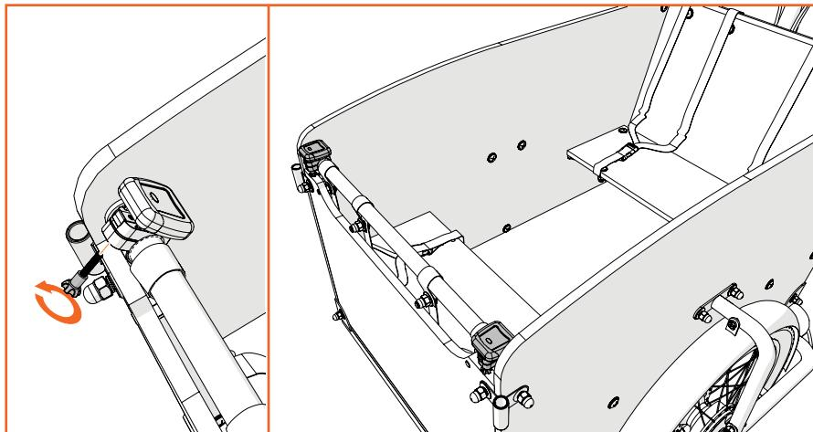
Ziehen Sie den Streifen („pull“) aus den Scheinwerfern. Schieben Sie die Lampe von der Klemme, schrauben Sie die Klemme auf und platzieren Sie diese an der Vorderstange in der Nähe der Seitenwand. Schrauben Sie die Klemme fest und platzieren Sie die Lampe. Wiederholen Sie dies für die andere Seite.
