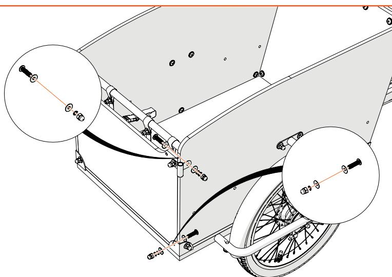
Bevestig het voorpaneel aan het frame en de zijpanelen met boutenset C.
