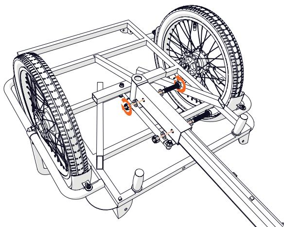
Gebruik boutenset H. Plaats de ring op de bout. Steek dan de bout door het frame. Plaats de tweede ring op de bout. Plaats de moer en draai deze handvast aan. Draai de moer nog niet helemaal vast, dat komt later. Gebruik hiervoor twee 17 mm ring- of steeksleutels.
