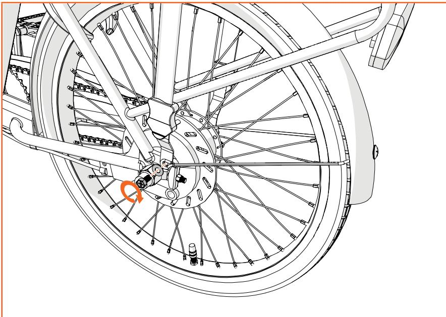
Draai de schroef los, en plaats de spatbordstang. Schroef de spatbordstang vast en herhaal voor de andere kant.
