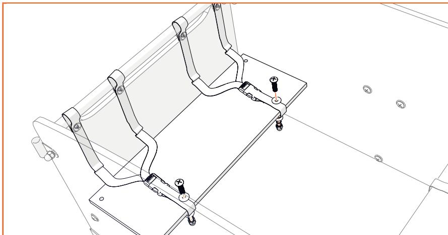
Serrez bien tous les boulons et écrous et fixez le garde-boue avant.
