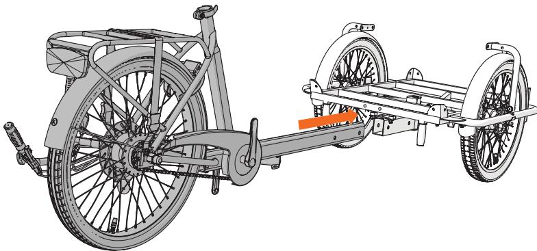
Bitten Sie für diesen Schritt eventuell jemanden um Hilfe. Platzieren Sie den vorderen Rahmen aufrecht und halten ihn horizontal. Schieben Sie das Rohr des hinteren Rahmens in den vorderen Rahmen. Kontrollieren Sie, ob das Rohr festsitzt. Sollte noch Spiel zwischen dem vorderen und hinteren Rahmen sein, verwenden Sie eine oder zwei Metallplatten (mitgeliefert), um dies auszugleichen.
