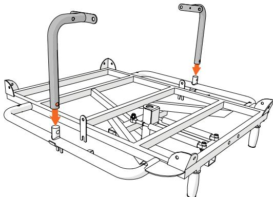
Placez les supports latéraux sur les tubes verticaux, sur la partie supérieure du cadre. Veillez à ce que les trous de vis du support et du tube soient alignés. (Il peut arriver que le tube ne s'imbrique pas bien dans le support. Dans ce cas, poncez un peu la laque pour qu'ils s'imbriquent.)
