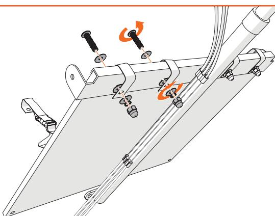
Fixez le panneau arrière avec deux ceintures sur la pièce en T. Si un siège coque pour bébé ou un siège enfant est placé dans le bac. La ceinture à cet endroit n'est pas nécessaire. Placez un siège coque pour bébé ou un siège enfant à gauche, pour qu'un enfant plus grand puisse monter depuis le trottoir (droite).
