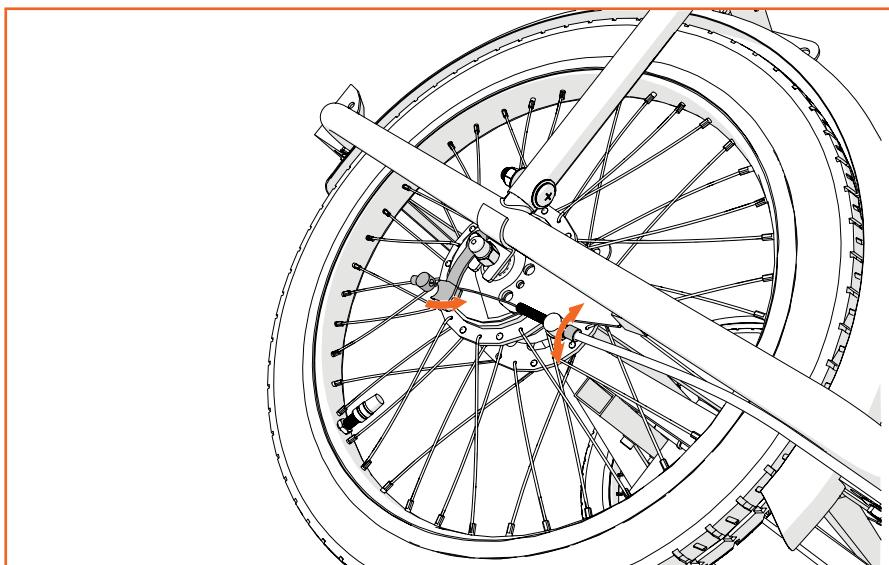
Les freins peuvent être resserrés ou desserrés ultérieurement à l'aide du boulon de réglage. Serrez le taquet de frein et décrochez le stoppeur de câble. Tournez le boulon de réglage dans le sens du cadre arrière pour resserrer le frein. Tournez le boulon de réglage dans le sens du cadre avant pour desserrer le frein. Resserrez le taquet de frein et remettez le stoppeur de câble à sa place. Regardez éventuellement la vidéo d'instruction sur notre site web.
