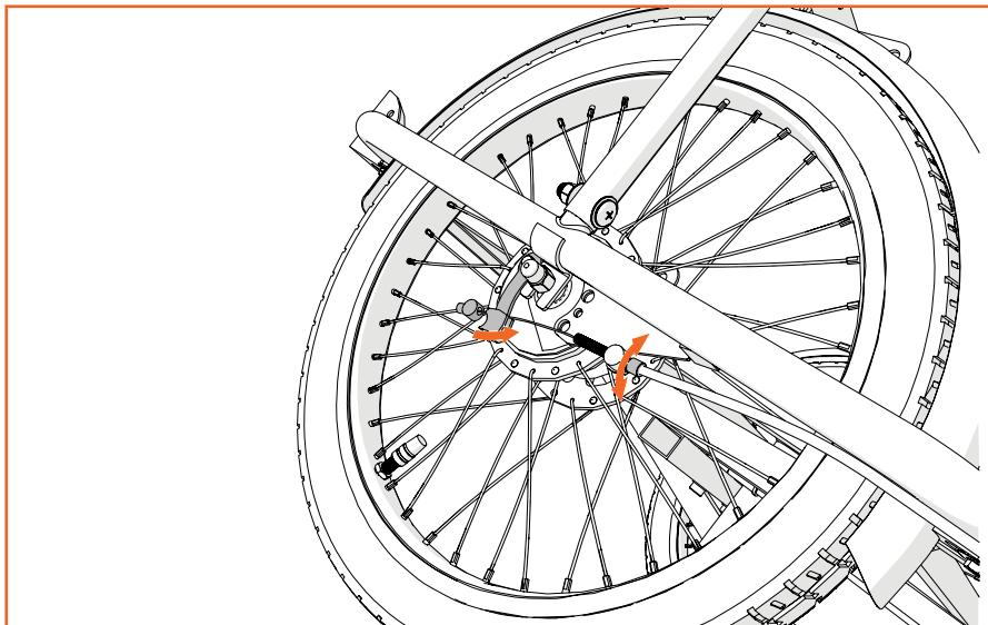
Met de stelbout kunnen de remmen achteraf strakker of losser afgesteld worden. Knijp de remklepel dicht en haak de kabelstopper los. Draai de stelbout in de richting van het achterframe om de rem strakker te stellen. Draai de stelbout in de richting van de voorkant om de rem losser af te stellen. Knijp de remklepel weer dicht en haak de kabelstopper weer op zijn plek. Bekijk eventueel ook de instructievideo op onze website.
