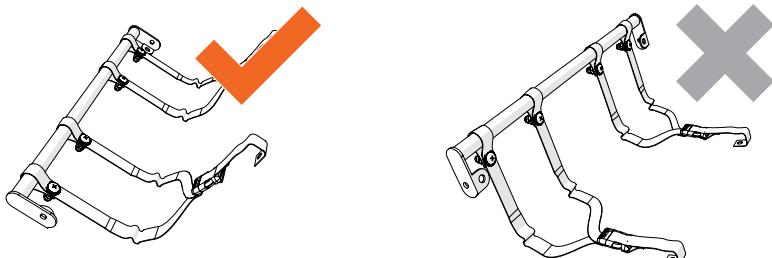
Befestigen Sie zwei Gurte mit Schraubensatz G an der Vorderstange. Achten Sie darauf, dass die Muttern an der Oberseite angebracht sind.
