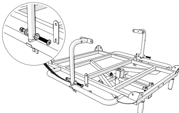
Utilisez les boulons et écrous du kit F pour fixer les supports. Ne les serrez pas encore trop, ce sera pour plus tard.
