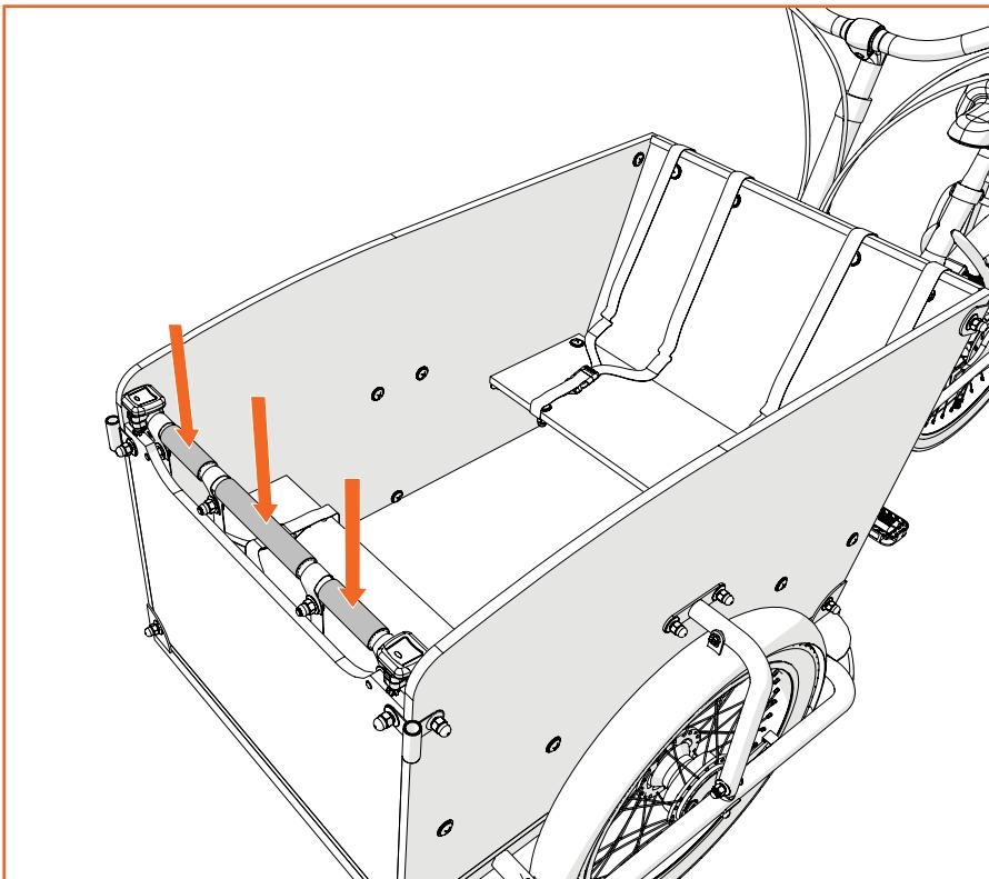
Platzieren Sie die Schaumstoffmuffen zwischen den Gurten an der Vorderstange.
