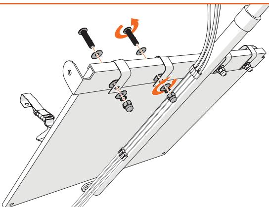
Befestigen Sie die Rückwand gleichzeitig mit zwei Gurten am T-Stück. Wenn eine Babyschale oder ein Kindersitz in der Transportbox montiert wird, dann wird ein Gurt an dieser Stelle nicht benötigt. Platzieren Sie Babyschale oder Kindersitz links, sodass ein größeres Kind selbstständig von der Seite der Bordsteinkante einsteigen kann (rechts).
