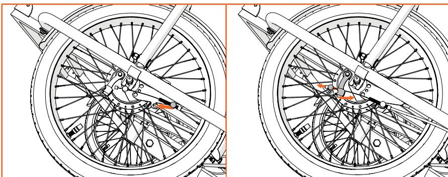
Zorg dat de kabels netjes door de houders aan het T-stuk lopen. Let op! De kabel die met "L" gemarkeerd is, is langer. Leid deze aan de binnenkant om de kantelstopper heen naar het oog (U-profiel) en plaats de stelbout in de gleuf van het remanker. Knijp de remklepel dicht en haak de kabelstopper erachter. Herhaal de stappen voor de rechterkabel. Bevestig de kabels aan het frame met de bijgeleverde tie-wraps.
