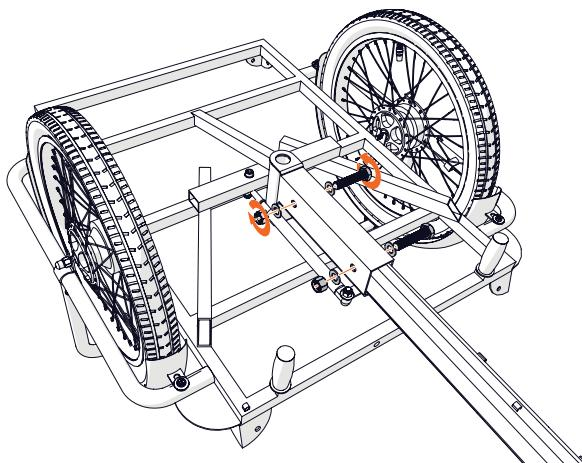
Verwenden Sie Schraubensatz H. Platzieren Sie den Ring auf der Schraube. Stecken Sie dann die Schraube durch den Rahmen. Platzieren Sie den zweiten Ring auf der Schraube. Platzieren Sie die Mutter und ziehen Sie sie handfest an. Ziehen Sie sie noch nicht komplett fest, dies folgt später. Verwenden Sie hierfür zwei 17-mm-Ring- oder Maulschlüssel.
