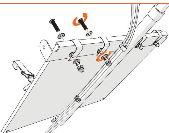
Bevestig het achterpaneel tegelijk met twee gordeltjes op het T-stuk. Indien er een babyschaal of peuterstoel in de bak wordt gemonteerd, dan is het gordeltje op die plek niet nodig. Plaats een babyschaal of peuterstoel links, zodat een groter kind zelfstandig kan instappen vanaf de stoepkant (rechts).
