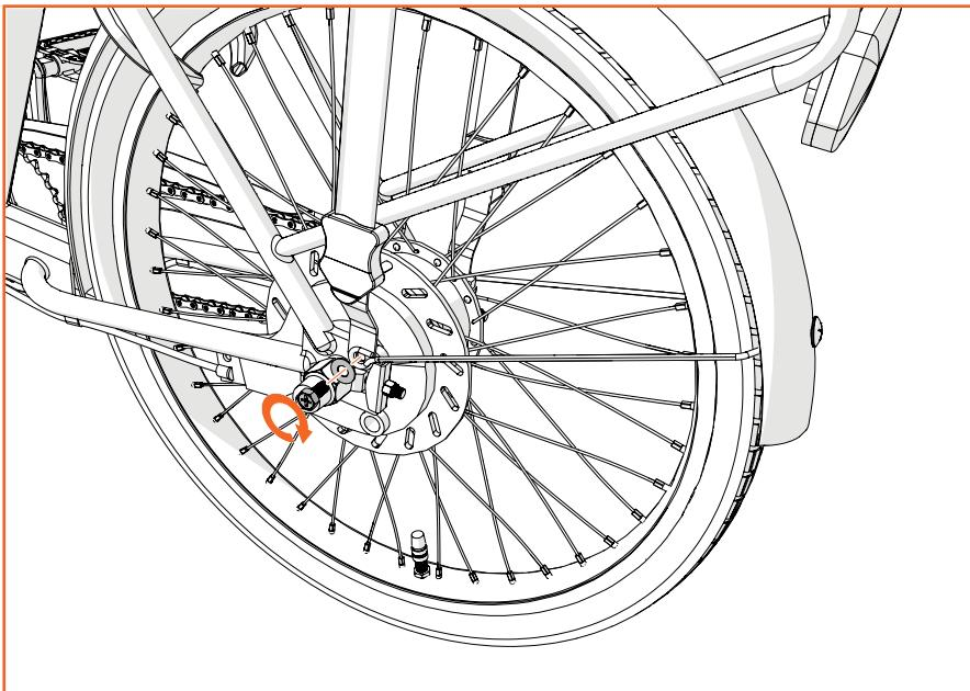
Lösen Sie die Schraube und platzieren Sie die Schutzblechstrebe. Schrauben Sie die Schutzblechstrebe fest und wiederholen Sie dies für die andere Seite.
