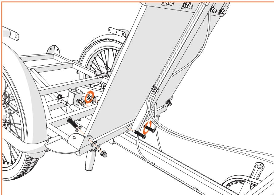
Placez le panneau arrière avec la pièce en T sur le cadre avant. Veillez à ce que les câbles de frein ne soient pas tournés et les ceintures ne passent pas entre le cadre et le panneau arrière. Fixez la pièce en T au cadre avant à l'aide du kit de boulons E. Puis fixez le panneau arrière au cadre avant à l'aide du kit de boulons C. Ne resserrez pas encore trop le boulon C.
