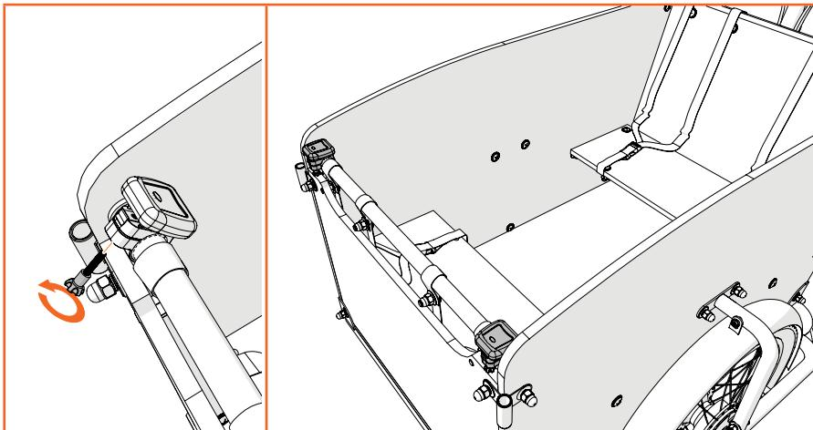
Trek de strip (“pull”) uit de lampjes. Schuif het lampje van de klem, schroef de klem open en plaats deze op de voorstang in de buurt van het zijpaneel. Schroef de klem vast en plaats het lampje. Herhaal voor de andere kant.
