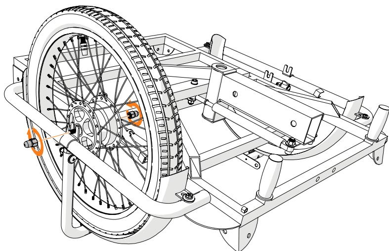
Placez le cadre avant à l'envers. Dévissez le boulon de la roue avant et placez l'axe dans le cadre et la barre de frein dans l'encadrement. Resserrez le boulon. Répétez l'étape pour l'autre côté.
