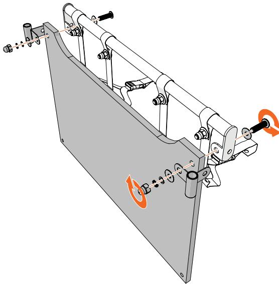
Befestigen Sie die Vorderwand mit Schraubensatz C an der Vorderstange. Stellen Sie sicher, dass die Muttern an der Außenseite angebracht sind.
