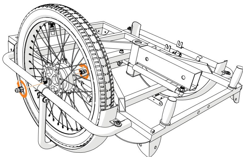
Plaats het voorframe ondersteboven. Draai de bouten van het voorwiel los en plaats de as in het frame en de remstang in het oog. Draai de bouten strak aan. Herhaal dit voor de andere kant.
