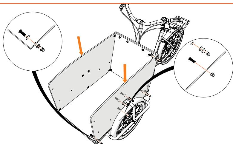
Posez le panneau de fond dans le cadre avant. Placez les panneaux latéraux et fixez-les au cadre avant à l'aide du kit de boulons C. Utilisez le kit de boulons D pour l'œillet derrière la roue. Veillez à ce que tous les écrous à l'extérieur du bac soient installés.
