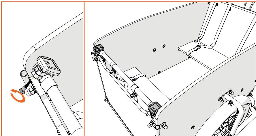
Tirez le film («pull») des lampes. Faites glisser la lampe du support, dévissez le support et placez-le sur la barre avant, près du panneau latéral. Revissez le support et placez la lampe. Répétez de l'autre côté.
