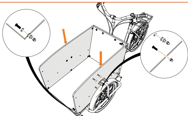
Leg het bodempaneel in het voorframe. Plaats de zijpanelen en bevestig ze aan het voorframe met boutenset C. Gebruik boutenset D voor het oog achter het wiel. Zorg dat alle moeren aan de buitenkant van de bak zijn aangebracht.
