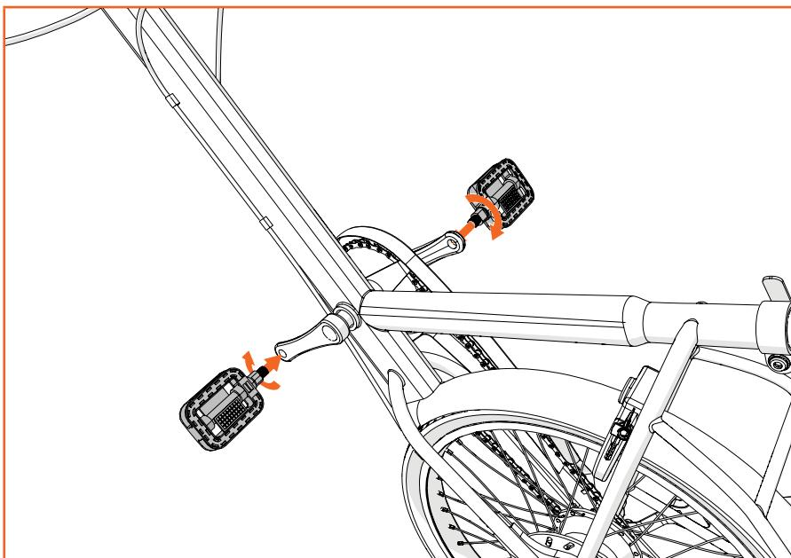
Het linker pedaal is gemarkeerd met "L". Draai het met de hand met de klok mee in de linker crank. Draai het rechter pedaal tegen de klok in vast in de rechter crank. Gebruik steeksleutel 15 om de trappers vast te zetten.
