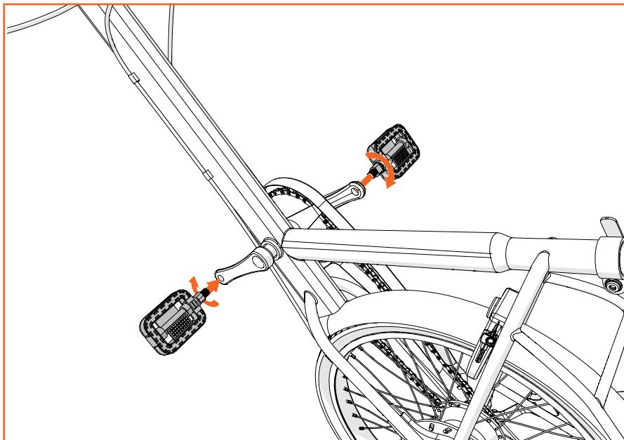
La pédale est marquée de la lettre «L». À la main, vissez-la dans le sens des aiguilles d'une montre dans le pédalier gauche. Vissez dans le sens contraire des aiguilles d'une montre la pédale de droite dans le pédalier droit. Utilisez la clé anglaise 15 pour fixer les pédales.
