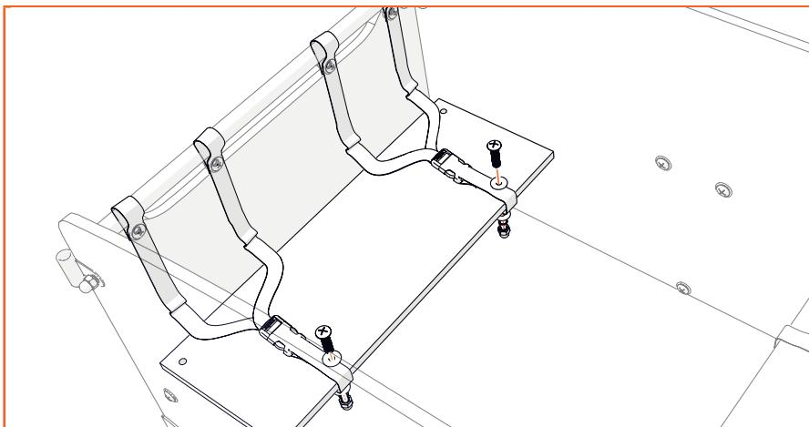
Ziehen Sie nun alle Schrauben und Muttern fest an und richten Sie die vorderen Schutzbleche aus.
