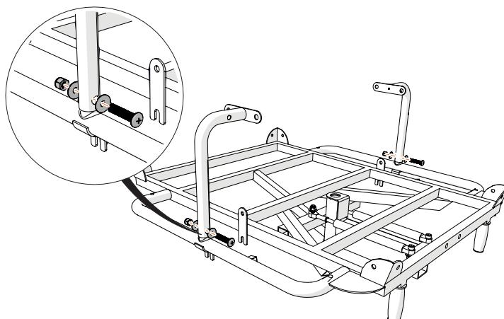
Gebruik de bouten en moeren uit set F om de beugels vast te zetten. Zet ze nog niet te strak vast, dat komt later.
