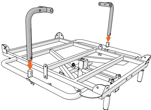
Plaats de zijbeugels over de opstaande buizen op de bovenkant van het frame. Zorg dat de schrooggaten in beugel en buis uitgelijnd zijn. (Het kan weleens voorkomen dat de beugel niet precies over de buis heen past. Schuur in dat geval een beetje van de lak weg om het passend te maken.)
