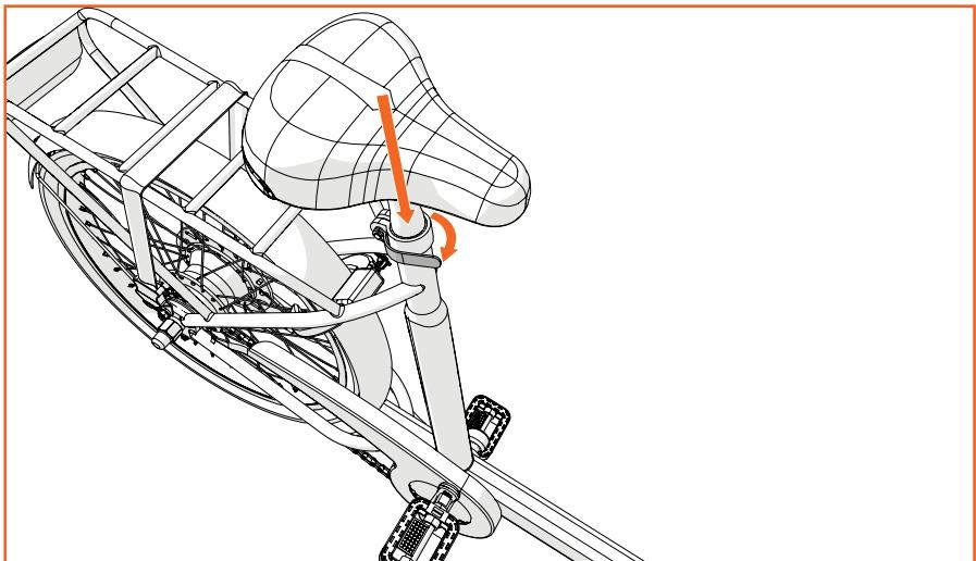
Schieben Sie die Sattelstütze in das Sattelrohr und ziehen Sie alles mit dem Schnellspanner fest. Prüfen Sie, ob der Sattel fest auf der Sattelstütze sitzt und ziehen Sie – falls nötig – die Muttern weiter an.
