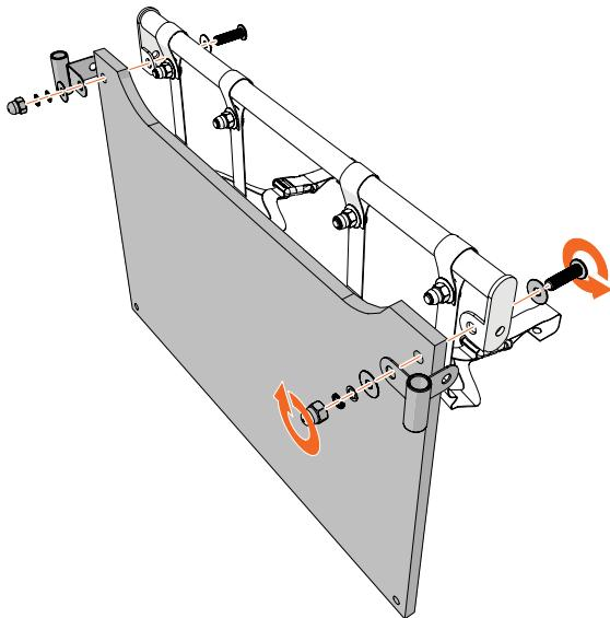
Fixez le panneau avant à la barre avant à l'aide du kit de boulons C. Veillez à ce que les écrous soient placés à l'extérieur.
