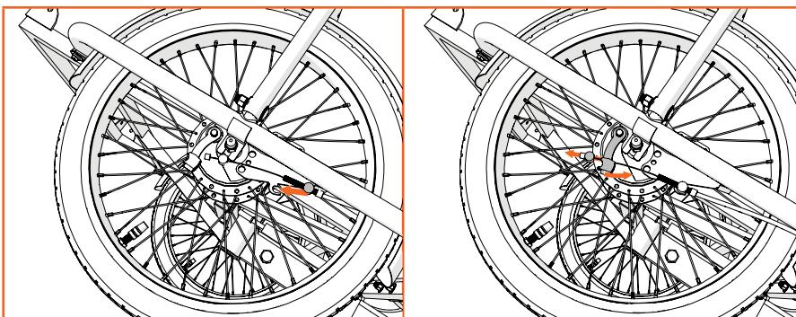
Veillez à ce que les câbles passent bien dans les supports fixés à la pièce en T. Attention ! Le câble marqué de la lettre «L» est plus long. Dirigez-les à l'intérieur autour du bloc anti-basculement vers l'œillet (profil U) et placez le boulon de réglage dans la fente de l'étrier de frein. Serrez le levier de frein et accrochez le stoppeur de câble derrière. Répétez les étapes pour le câble droit. Fixez les câbles au cadre à l'aide des serre-câbles inclus.
