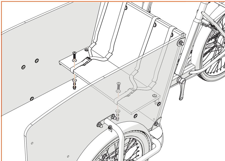
Befestigen Sie die Eckstücke mit Schraubensatz C an einer der Sitzflächen. Platzieren Sie die Sitzfläche gegen die Rückwand und verwenden Sie Schraubensatz B, um die Sitzfläche an den Seitenwänden zu befestigen. Stellen Sie sicher, dass die Muttern an der Innenseite angebracht sind. Befestigen Sie die Gurte mit Schraubensatz C an der Unterseite der Sitzfläche. Achten Sie darauf, dass die Muttern an der Unterseite angebracht sind.
