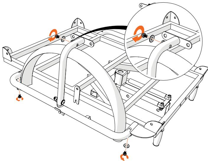
Desserrez la vis en haut du support, puis les vis du cadre.
