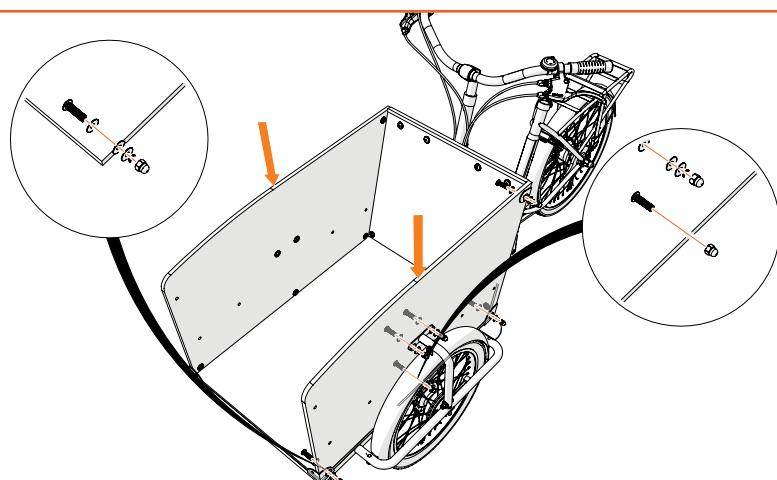
Legen Sie die Bodenplatte in den Vorderrahmen. Platzieren Sie die Seitenwände und befestigen Sie diese mit dem Schraubensatz C am vorderen Rahmen. Verwenden Sie Schraubensatz D für das Auge hinter dem Rad. Stellen Sie sicher, dass alle Muttern an der Außenseite der Transportbox angebracht sind.
