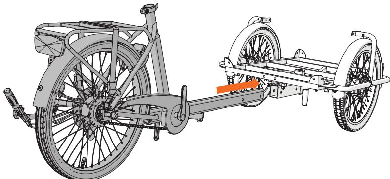
Pour cette étape, demandez éventuellement l'aide de quelqu'un. Placez le cadre avant de façon à ce qu'il soit droit et tenez-le à l'horizontale. Glissez le tube du cadre arrière dans le cadre avant. Vérifiez si le tube est bien fixé. S'il y a du jeu entre le cadre avant et arrière, utilisez une ou deux plaquettes en métal (incluses) pour bien les fixer.
