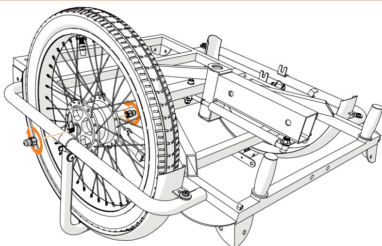
Platzieren Sie den vorderen Rahmen verkehrt herum. Lösen Sie die Schrauben des Vorderrades und platzieren Sie das Lager im Rahmen und die Bremsstange im Auge. Ziehen Sie die Schrauben fest an. Wiederholen Sie dies für die andere Seite.
