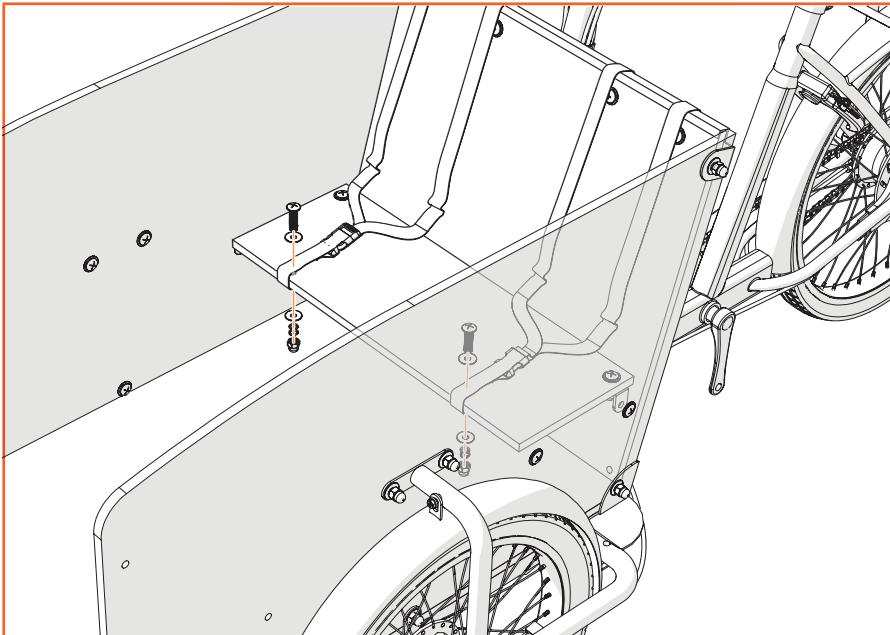
Fixez les pièces d'angle sur l'un des bancs à l'aide du kit de boulons C. Placez le banc contre le panneau arrière et utilisez le kit de boulons B pour fixer le banc aux panneaux latéraux. Veillez à ce que les écrous soient placés à l'intérieur. À l'aide du kit de boulons C, fixez les ceintures sous le banc. Veillez à ce que les écrous soient placés sur le dessous.
