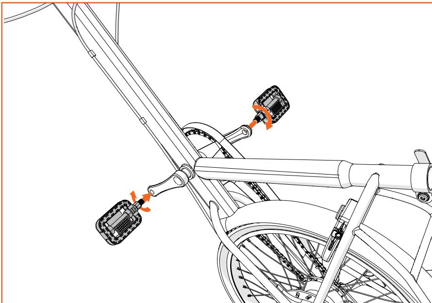
Das linke Pedal ist mit einem „L“ markiert. Drehen Sie es mit der Hand im Uhrzeigersinn in den linken Kurbelarm. Drehen Sie das rechte Pedal gegen den Uhrzeigersinn in den rechten Kurbelarm. Verwenden Sie Schraubenschlüssel 15, um die Pedale festzuziehen.
