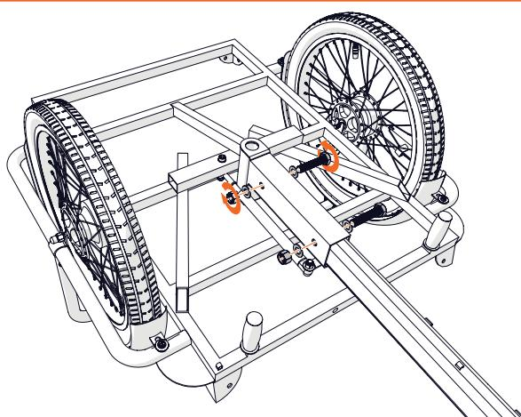
Utilisez le kit de boulons H. Placez la rondelle sur le boulon, puis passez le boulon dans le cadre. Placez la deuxième rondelle sur le boulon. Placez l'écrou et resserrez-le à la main. Ne resserrez pas encore complètement l'écrou, ce sera pour plus tard. Pour cela, utilisez deux clés anglaises ou clés de calibre de 17 mm.
