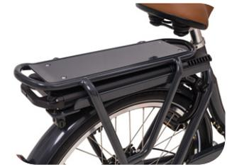
Zum abkoppeln des Akkus schließen Sie das Akkus Schloss auf indem Sie den Schlüssel rechtsum drehen. Anschließend ziehen Sie den Akku mit Hilfe des Handgriffes aus der Controllerbox.
