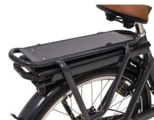
Si vous voulez retirer la batterie, déverrouillez au préalable le support de batterie en tournant la clé de batterie vers la droite. Retirez ensuite la batterie de la boîte de contrôle en tirant la poignée sur le bas de la batterie.
