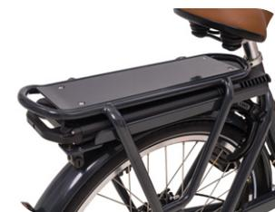
Wanneer u de accu wilt loskoppelen, ontgrendelt u eerst het accuslot door de accusleutel rechtsom te draaien. Vervolgens haalt u de accu uit de controllerbox door deze via het handvat aan de onderkant van de accu eruit te trekken.
