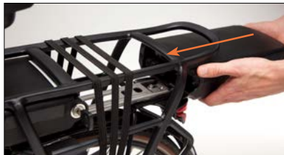
Plaatsen van de accu
