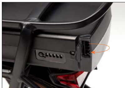
Afscherming oplaadaansluiting openen
