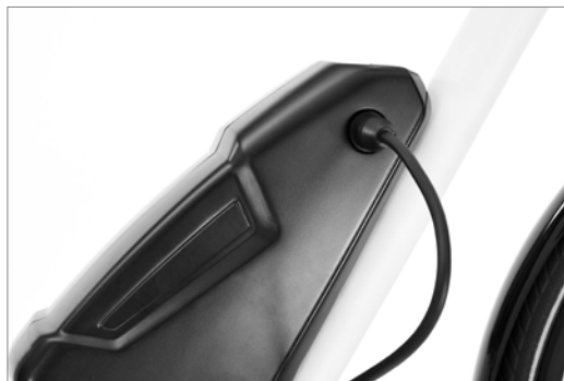
Aufladen der Batterie
