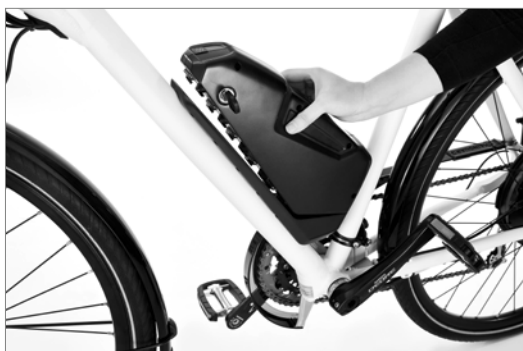
Mise en place de la batterie
