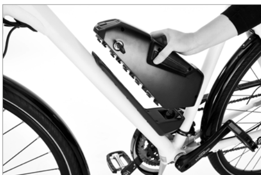
Extracción de la batería
