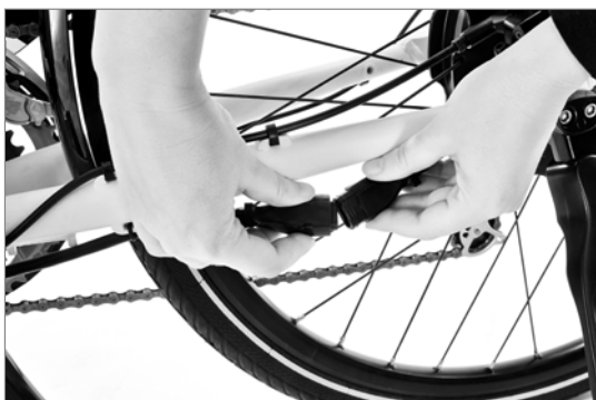
Débranchement du câble
