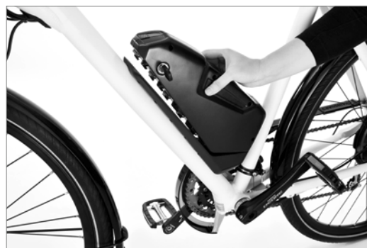
Mise en place de la batterie
