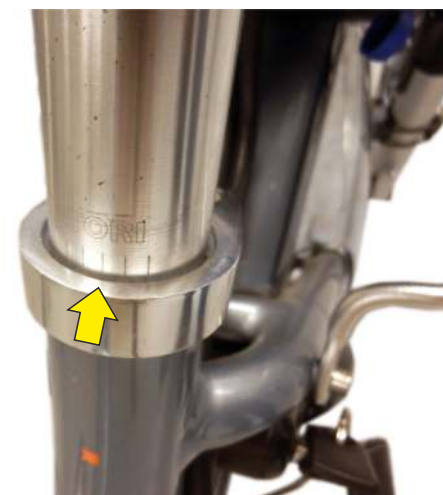
De streepjes op de zadelpen geven de maximaal hoogte aan. Vanaf hier niet hoger zetten!
