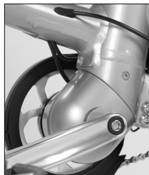
Aandrijffunit met ingebouwde trapkracht- en rotatiesensor
