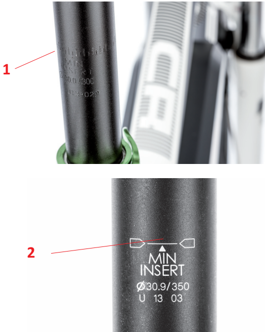
Afbeelding 10: Markering tot waar de zadelpen minstens in het frame moet steken. (voorbeelden)
