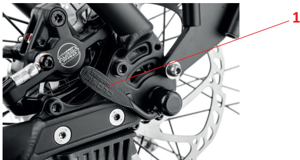
Afbeelding 16: Montage van de snelsluiser in het achterwiel volgens de voorschriften
