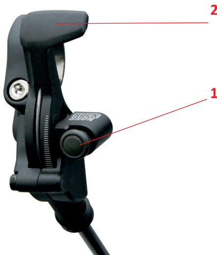
1 Ontgrendel hendel 2 blokkeerhendel
