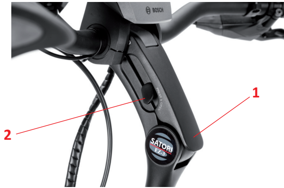
Afbeelding 8: stuurafstelling bij gereedschap loze stuurpen
