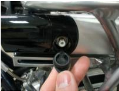
Haal de rubberdop voorzichtig uit de accu
