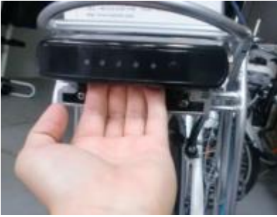
Trek de accu naar achteren uit de bagagedrager
