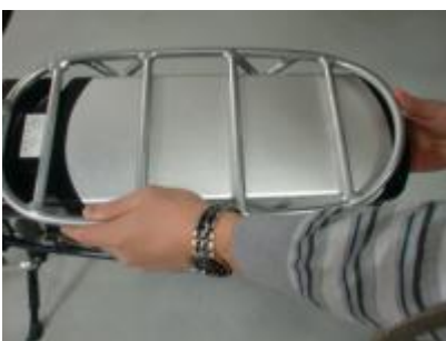
Druk de accu goed aan in de controller
