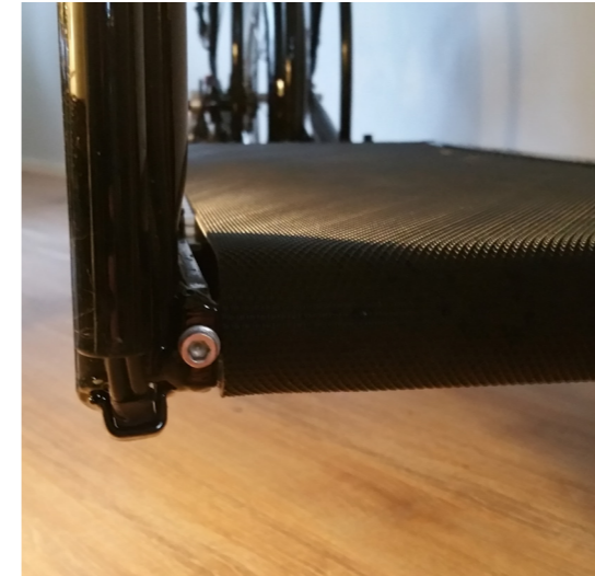
Afbeelding 7: Stelschroef van de loopband, links.
