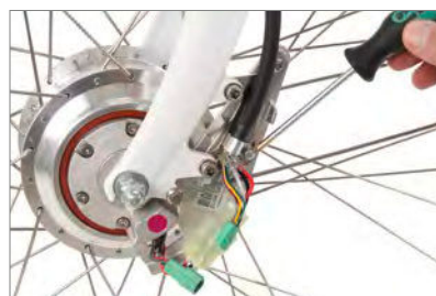
Basisplaat met kabels en stekkers
