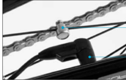
1 Speichenmagnet 2 Sensor an Hinterradrohr
