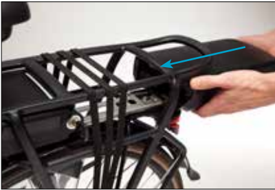
Plaatsen van de accu
