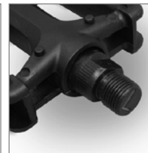
As met schroefdraad van linker pedaal
