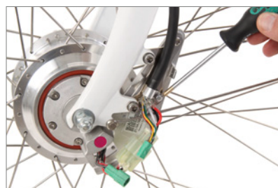
Basisplaat met kabels en stekkers
