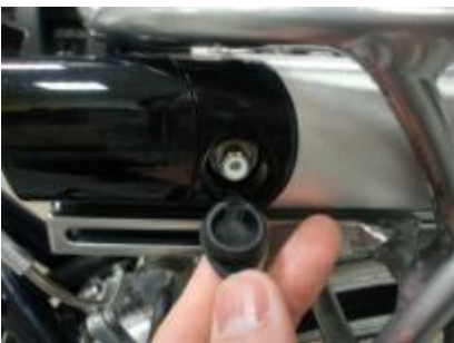
Haal de rubberdop voorzichtig uit de accu
