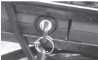
Contactslot voor in accu De sleutel is inklapbaar
