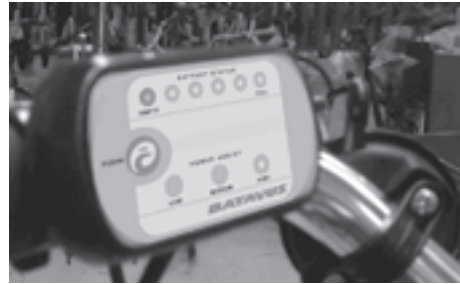
Bedieningsdisplay op stuur Bovenste lampjes geven accucapaciteit aan Onderste lampjes geven de ondersteuningstand aan (low, medium, high)
